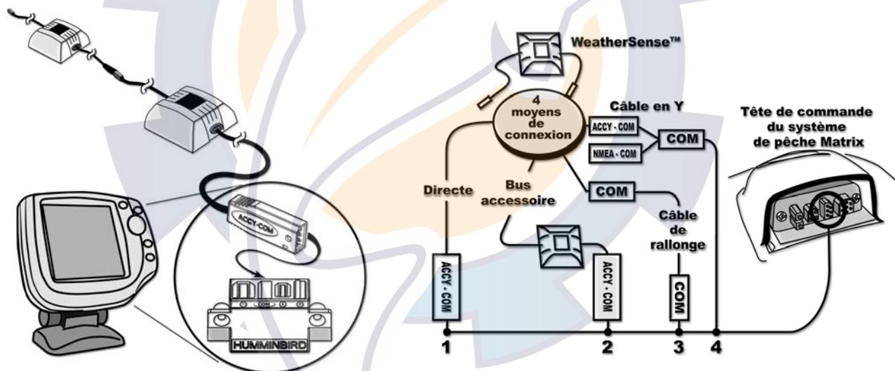
**REMARQUE :** Si vous utilisez le câble en Y (en option) pour connecter un accessoire GPS et le WeatherSense à votre système Matrix, branchez l'extrémité simple du câble en Y au Matrix, puis le câble du WeatherSense à l'une des branches du Y (qui devrait être muni d'un connecteur semblable à celui se trouvant sur le Matrix lui-même). Branchez le câble de l'accessoire GPS dans l'autre branche du câble en Y.
