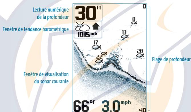
La fenêtre **WeatherSense View** (visualisation du WeatherSense) s'ajoute automatiquement à la liste activée par le bouton de visualisation; il est donc possible d'y accéder en appuyant sur le bouton **VIEW** (visualisation). Toutes les fenêtres de visualisation du système Matrix, incluant celle du WeatherSense, peuvent être retirées de la liste de roulement, ou ajoutées à cette liste, au moyen du menu de sélection des affichages (voir le mode d'emploi du Matrix).
